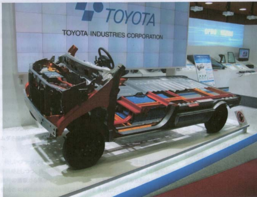
図◎EV専用プラットフォーム。軽自動車からコンパクトカーまでの小型EVのプラットフォームを想定して開発した。黄色、オレンジ色、赤色の部分に高張力鋼使用した。
