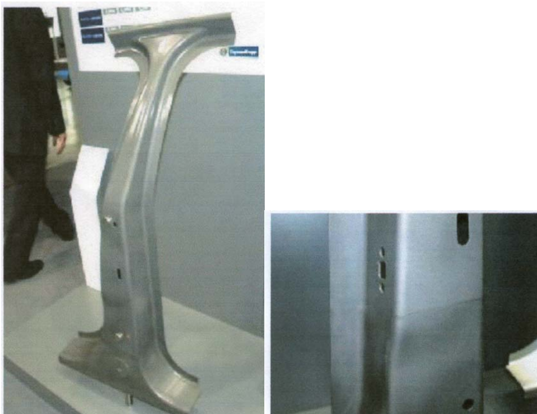
図 71 ThyssenKrupp 社の局所焼入れによる軽量化と原低 (51)
