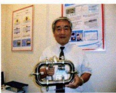
TOKIエンジニアリング代表取締役の小柳悟氏。両手で持つ金属性パイプの継ぎ手部分に、ステンレスパッキングを使用。長期間交換が不要であることを主張するため、同パイプ全体をワイヤーとカギで完全ロックした。
